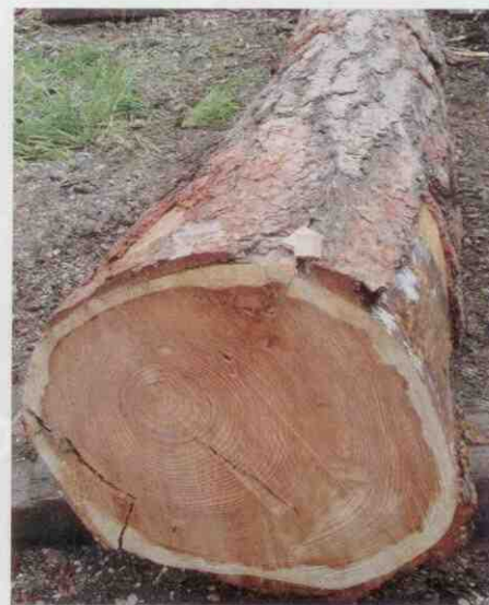
Exzentrischer Wuchs und Krümmung am Beispiel eines Lärchenstammes.
