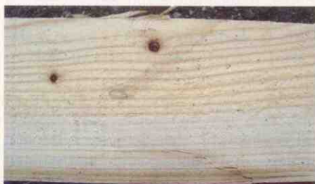
Tannenbrett mit schwarzen Ästen und stark ausgeprägtem «Buch» (Reaktionsholz) und «Stachriss» infolge starker Windbelastung im unteren Teil.
